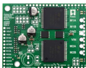
Fig. 5.13: Placa de comandă a motoarelor Pololu Dual VN5019 [WWW 7]
