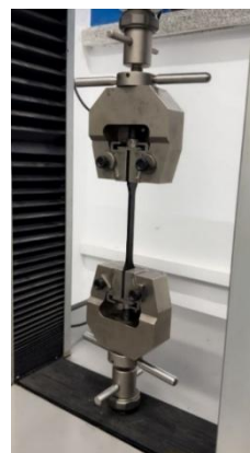
Figura 3.3 Mașina universală de testare Galdabini Quasar 25 kN
