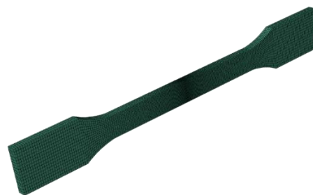
Figura 5.3 Model 3D al epruvetei de tracțiune discretizat în elemente finite
