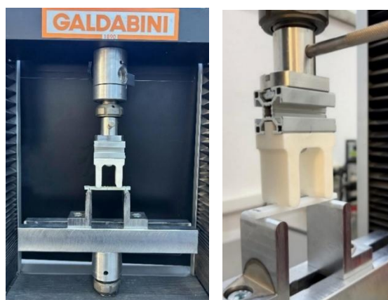
Figura 4.4 Dispozitiv pentru încercarea la încovoiere în patru puncte
