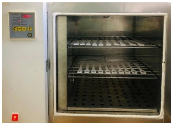
Figura 3.2 Etuva utilizată pentru uscarea epruvetelor timp de 24 h la 500 C
