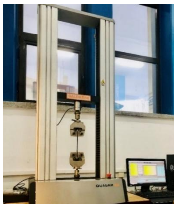
Figura 3.3 Mașina universală de testare Galdabini Quasar 25 kN
