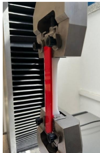
b) Epruvetă atașată pe mașina de testare folosind dispozitivul de orientare
