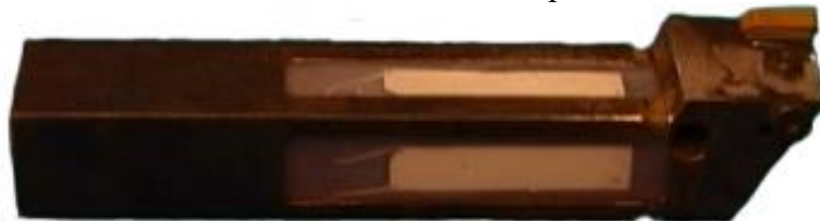
Figura 1.2. Prima încercare a unei soluții active de suport pentru scule folosind tehnica piezo - ceramică pentru atenuarea vibrațiilor [56]
