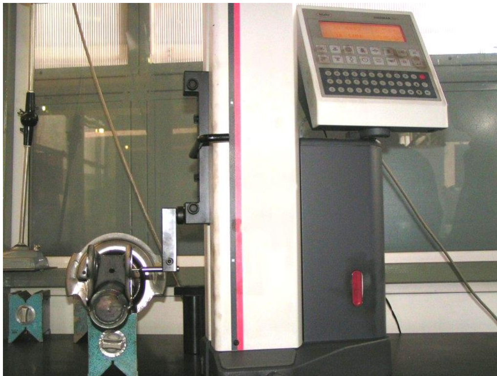
Fig. 6.11. Măsurarea piesei pe mașina în coordonate 2d (coloană de măsură Digimar DX1)
