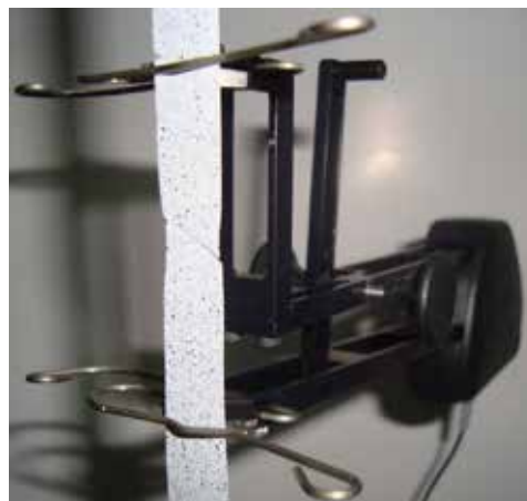
b. Detaliu cu extensometru montat pe epruvetă
