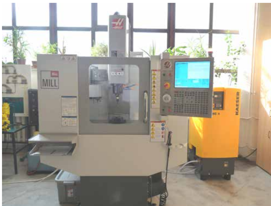
Fig. 4.14. Centrul de prelucrare prin frezare CNC Haas MiniMill
