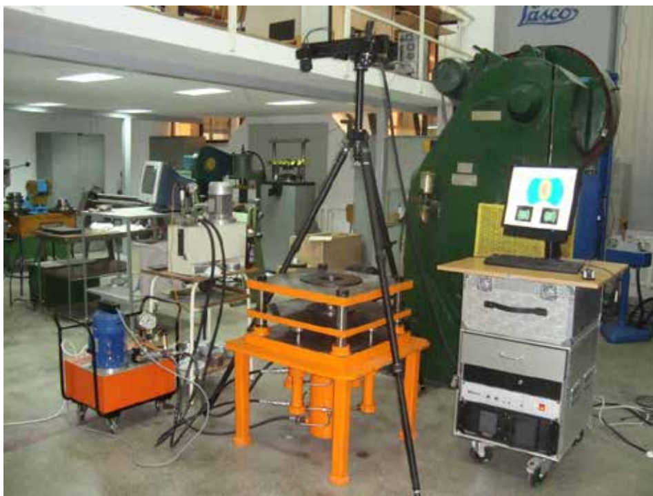
Fig. 3.11. Standul experimental pentru determinarea curbelor limită de deformare
