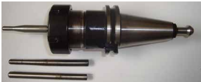
Fig. 4.13. Portscula și poansoanele utilizate
