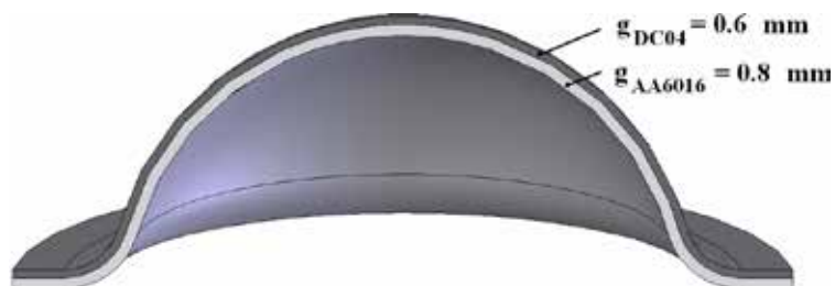
Fig. 4.26. Modelul 3D al piesei de formă emisferică
