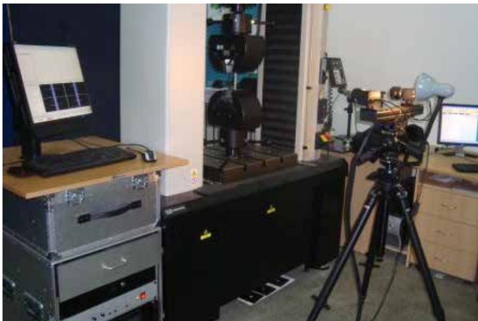
Fig. 3.3. Standul experimental utilizat pentru încercarea la tracțiune
